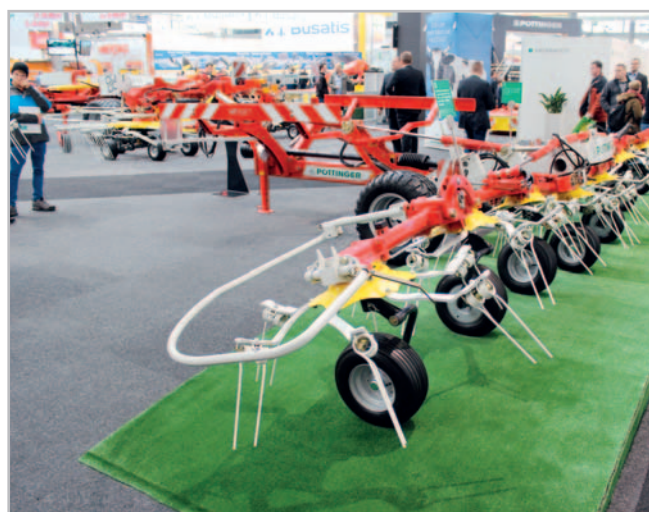
Tažené obraceče firmy Pöttinger s vlastním podvozkem mají nový přírůstek v podobě osmirotorového obraceče Hit 8.9 T – kompaktní model se záběrem 8,86 m. Samostatné uložení rotorů dovoluje plynulé kopírování terénu
