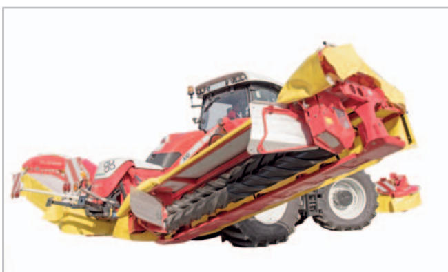
Žací kombinace NovaCat A10 může být osazena válcovým mačkačem RCB, prstovým kondicionérem anebo pracovat v provozu sólo. U obou zařízení pro úpravu píce je také možný shazovací dopravník Collector
