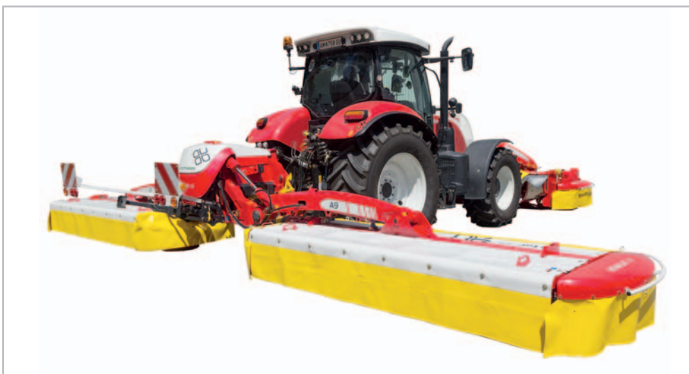
Nová žací kombinace NovaCat A9 přináší všechny osvědčené konstrukční prvky modelu A10 v pracovním záběru 8,92 nebo 9,18 m
