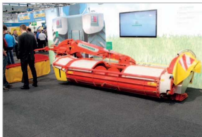
Se žacím strojem NovaCat 352 CF nabízí firma Pöttinger možnost shazování pokosu na jeden řádek od dvou nesených žacích strojů při jedné jízdě
