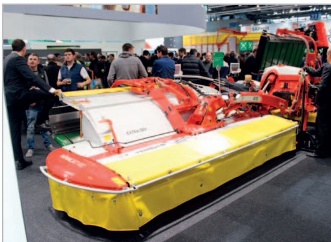
Žací kombinace NovaCat A10 byla na veletrhu Agritechnica prezentována v provedení s pásovémi dopravníky Collector. Dopravníky je také možné kdykoli demontovat, například pro vysekávání pastvin, a na jaře pak opět připojit. Práci dopravníků mohou dále „perfekcionalizovat“ nové automatické funkce
